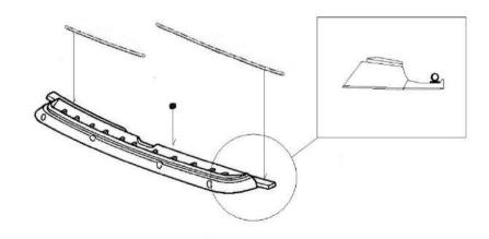
※エアーダクト取り付けのためのプラスチック部に水漏れを防ぐよう少量のシール材を塗布することをお勧めします。
